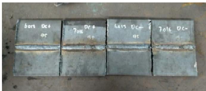
**Gambar 2 Hasil pengelasan pada baja**
