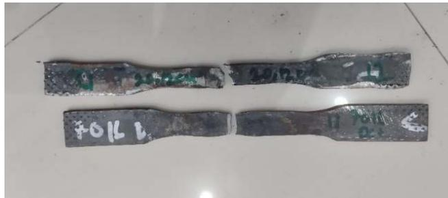
**Gambar 4 Spesimen yang sudah diuji tarik**
