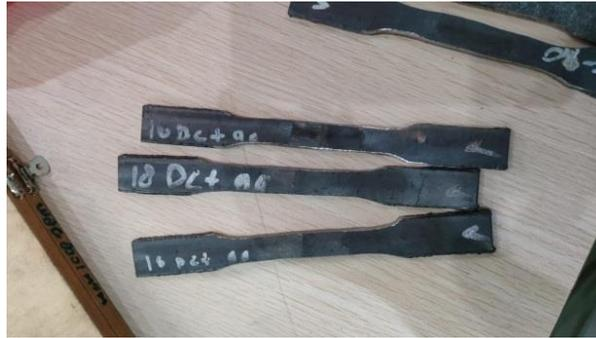
Gambar 2 Spesimen Setelah Dilakukan Uji tarik
