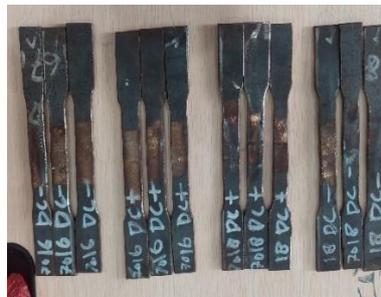
Gambar 3. Spesimen siap diuji tarik
