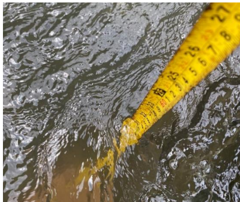
Gambar 4. 12 Pengukuran Tinggi Air Secara Manual
