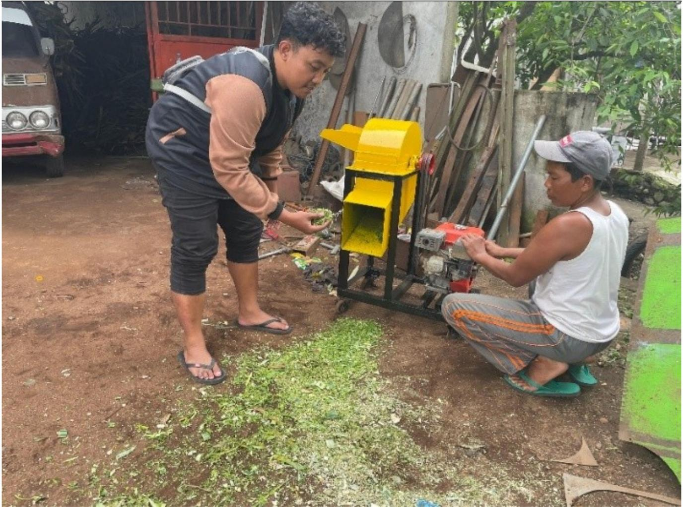
**Figure 9.** Uji Coba Mesin Pencacah Limbah Bonggol Nanas
