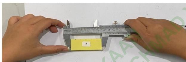
**Gambar 3.13 Proses Pengukuran Spesimen**
